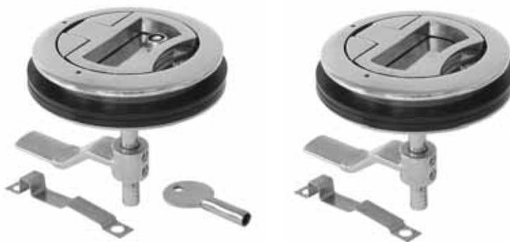
Cierre de tambucho con tirador modelo rectangular. Fabricado en acero inoxidable Aisi-316. Contramarco de acero inoxidable Aisi-316. Altura de cierre regulable. Posibilidad de abrirlas desde el interior.
