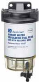
Filtro de combustible para fuerabordas con cabezal de aluminio, cazoleta transparente y racores. Filtro de 10 micras. Reemplaza filtro RacorS3227. Medidas 230x106 mm. Rosca del cabezal: 3/8" NTP. Manguera 10 mm.
