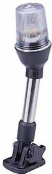
Luz todo horizonte abatible (360°) con un moderno sistema de lente que reduce el deslumbramiento, fabricada en ABS color negro con lente especial de material acrílico y mástil de acero inoxidable. Para embarcaciones inferiores a 12m. Alimentación: 12 v, bombilla: 10 w. Bombilla 501030.
