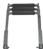
Escaleras plegables fabricadas con tubos de acero inoxidable electropulido de 19, 25 y 32 mm, peldaños con material plástico antideslizante. Los soportes disponen de un tope para evitar el balanceo de la escalera. Anchura 300 mm.
