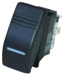
Interruptores iluminados fabricados en material plástico de color negro. Conexiones faston, Intensidad 25 amp. a 12 v y 15 amp. a 24 v. Se pueden instalar directamente realizando un agujero de 21,5 x 36,8 mm ó utilizando las cajas soporte referencias 502219, 502220 y 502221.
