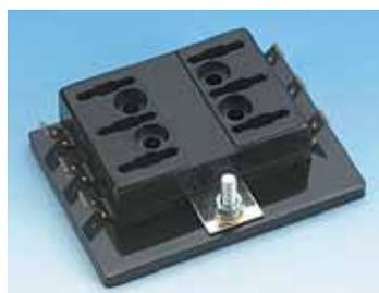
Para fusibles del modelo ATO/ATC. Voltaje: 12 v DC 25 Amp. máximo por circuito y terminales de 10 mm. fabricados en material termoplástico.
