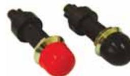
Con protector de neopreno, indicado para arranque. Fabricado en latón cromado. Intensidad máxima: 30 amp., diámetro de anclaje: 14 mm, longitud: 72 mm, diámetro: 28 mm.
