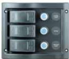
Modelo con 3 interruptores estancos con indicador LED y 3 disyuntores, dos de 10 A y uno de 5 A. Panel de plástico UV. Medidas: 130 x110 mm. Cumple normas CE.
