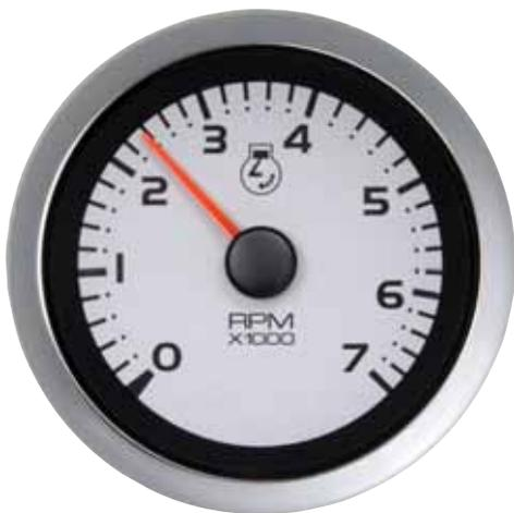
Para motores de gasolina. Iluminación interior. Motores fueraborda. Alimentación: 12 v. Diámetro de anclaje: 87 mm. Diámetro exterior: 96 mm. Dos posibilidades: Cuenta revoluciones solo o con cuenta horas incluido.
