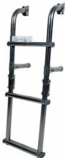
Para montaje en espejo de popa, plegable. Fabricada en tubo de acero inoxidable de 25 mm y con peldaños también en acero inox. Anchura: 270 mm.
