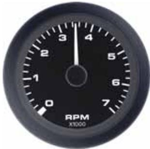
Para motores de gasolina. Iluminación interior. Motores fueraborda. Alimentación: 12 v. Diámetro de anclaje: 87 mm. Diámetro exterior: 96 mm. Dos posibilidades: Cuenta revoluciones solo o con cuenta horas incluido. Escala 0-7.000 r.p.m.
