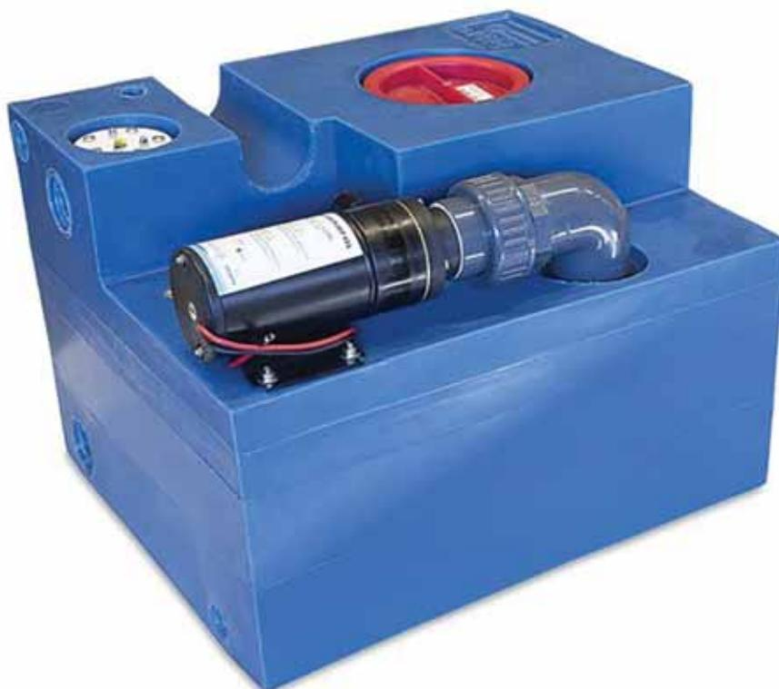
Kit completo de aguas residuales. Incluye un tanque rectangular de 72 l. de polietileno reforzado, bomba maceradora, filtro de carbón activo, panel de control, aforador de nivel y respiradero. Peso 25 Kg. Medidas: 700 x 300 x 400 mm. Certificado CE 94/25ECC. ISO8846 Small Craft.
