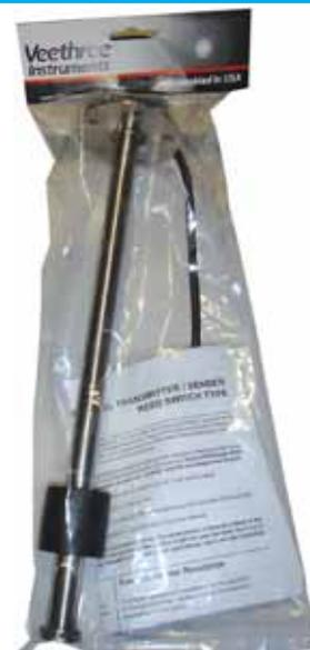
Aforador electrónico para combustible y agua. Fabricado en acero inoxidable AISI-316. Anclaje rosca 1,1/4" BSP. Resistencia de 240 ohms (Veethree, Faria USA, Veglia, Vetus, Aqua-Meter, etc.) Longitudes de 180 mm hasta 500 mm.
