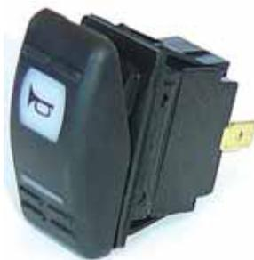
Interruptores con símbolos de función. Fabricados en material plástico de color negro, conexiones faston de latón. Intensidad 25 amp. a 12 v y 15 amp. a 24 v. Se pueden instalar directamente realizando un agujero de 21,5 x 36,8 mm ó utilizando las cajas soporte referencias 502219, 502220 y 502221.
