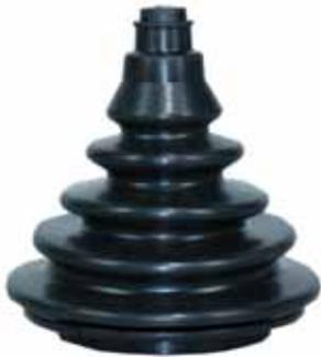
Pasacables para proteger los cables de dirección y control en la salida del casco y evitar la entrada de agua. Fabricado en PVC. Diámetro de la base 75 mm. Longitud total: 110 mm.
