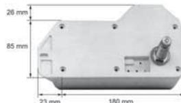
Ángulo de barrido regulable de 83° a 110°. Diámetro del eje: 16 mm. Alimentación: 12 v. Utiliza el brazo 601501 y 601534 y las escobillas 601502, 601503, 601537 y 601536. Utiliza los brazos paralelogramos 601531 y 601532.
