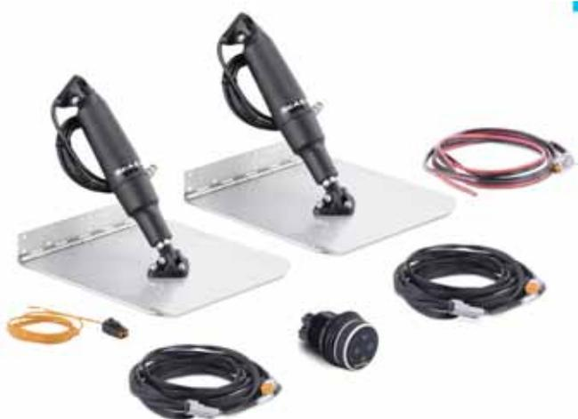
Flaps eléctricos con plancha estándar compuesto de: Actuadores 454006, controlador, cableado, herrajes y planchas de acero inox. 304 electropulidas. Voltaje: 9-16 A. Consumo medio: 10 A. Estanqueidad: IP56.
