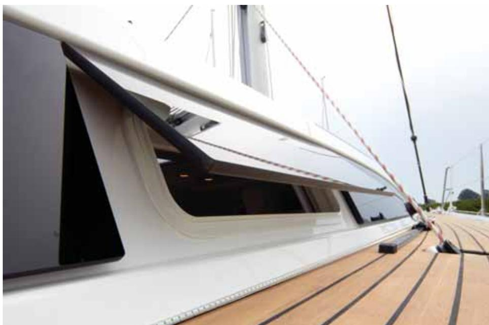
Nuevo portillo plano color de similar diseño que las escotillas planas, todas las bisagras y manetas se ocultan en el acrílico dando un exclusivo diseño «A Ras» hace que desde el exterior no se pueda ver ninguna diferencia entre los portillos fijos y los de abertura. Mirando desde el interior el PF es limpio y con gran visibilidad. Una única medida del es PF practicable y el resto todo a medida.
