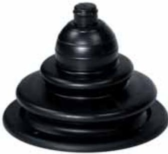
Pasacables para proteger los cables de dirección y control en la salida del casco y evitar la entrada de agua. Fabricado en PVC. Diámetro de la base 105mm. Longitud total: 150mm.
