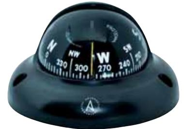
Compás sobre estribo para embarcaciones de motor o vela y embarcaciones de rescate. Lectura frontal. Rosa de 85 mm. Iluminación 12 o 24 v. Carátula antirreflejos. Graduación: cada 5°. Diámetro total 136 mm. Altura 150 mm. Certificación R.I.N.A. 0474/XX.
