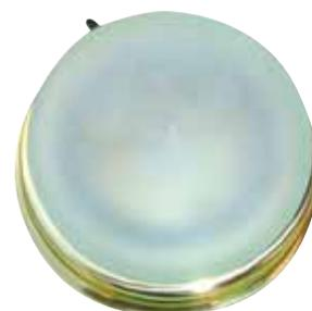
Plafón interior estanco. Fabricado en acero inoxidable AISI-316 con un baño de latón pulido. Óptica de vidrio translúcido. Con o sin interruptor incorporado. Medidas: 127 x 50 mm. Bombilla halógena de 12 v. 20 w. Bombilla 502053 y LED G-4.
