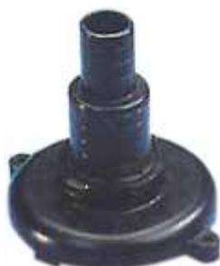
Fabricada en material plástico resistente a hidrocarburos. Filtro interior de neopreno que evita la entrada de residuos sólidos en la bomba, conector desmontable para una fácil limpieza. Para tubos de 24 y 36 mm.
