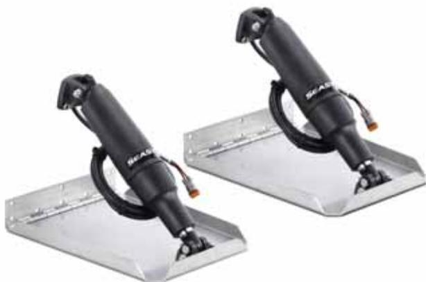
Flaps eléctricos con plancha montaje en borde ideal para espejos de popa cortos de altura compuesto de: Actuadores 454000, controlador, cableado, herrajes y planchas de acero inox. 304 electropulidas. Voltaje: 9-16 A. Consumo medio: 10 A. Estanqueidad: IP56.
