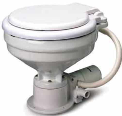
Taza de porcelana vitrificada, bomba horizontal de doble cuerpo. Asiento y tapa de material plástico, se puede instalar indistintamente tanto por encima como por debajo de la línea de flotación. Conexión de entrada: 25 mm. Conexión de salida: 25 mm. Medidas: 360x445x352 mm.
