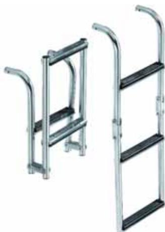
Para montaje en el espejo de popa. Plegables. Fabricadas con tubo de acero inoxidable con tratamiento electrolítico de 25 mm. Anchura: 270 mm.
