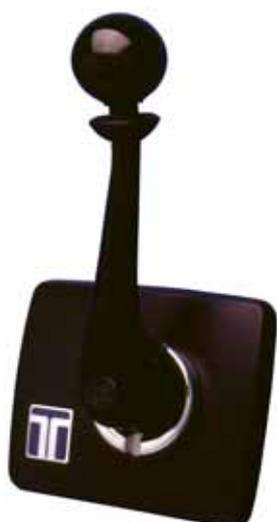
Mandos de control de palanca única y acción doble con interruptor neutro de seguridad (iinterlock). Montaje lateral. Dos modelos: Para Jet y para esquí náutico. La versión Jet es para motores Mercury Sport jet 90 y 120, OMC Turbo Jet o similares versiones. La versión esquí es para barcos con motores intraborda que requieren mucha suavidad y precisa aceleración. Los dos mandos son de similar apariencia pero llevan interruptores neutros diferentes, por lo tanto no se pueden intercambiar.
