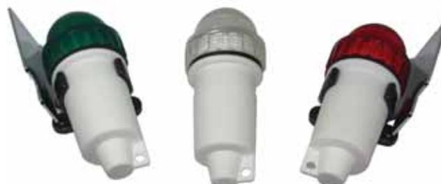
Luces de navegación de 12 v para embarcaciones inferiores a 20 m. Visibilidad 2 millas. Fabricadas en material plástico con lente de material acrílico y acero inoxidable AISI-316. Montaje vertical. Bombilla de 8 w. incluida. Bombilla 501213.
