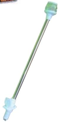
Luz todo horizonte desmontable (360°) para embarcaciones inferiores a 12 m, fabricada en policarbonato, lente de material acrílico y mástil de acero inoxidable. Altura: 540 mm. Alimentación: 12 v. Bombilla 501030.
