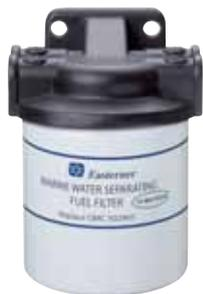
Filtro de combustible para fuerabordas e intrabordas con cabezal de aluminio y racores. Filtro de 10 micras. Reemplaza filtro Yamaha, OMC y universales. Rosca del cabezal: 3/8" NTP. Manguera 10 mm.
