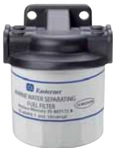
Filtro de combustible para fuerabordas e intrabordas con cabezal de aluminio y racores. Filtro de 10 micras. Reemplaza filtro Mercury y universales. Rosca del cabezal: 3/8" NTP. Manguera 10 mm.
