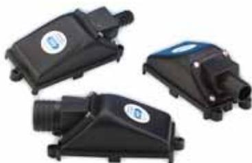
Filtros para evitar que los residuos de sentina bloqueen la manguera de entrada de la bomba y están equipados con una válvula de retención para detener el refluo de agua en la sentina. Disponible tanto para 19 mm, 25 mm y 38 mm (3/4 «, 1» y 1 1/2 «) de la manguera. Las tomas de salida se pueden ubicar de horizontal a vertical.
