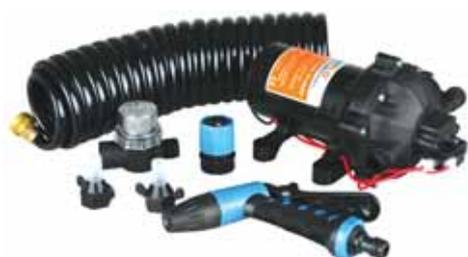
Kit de baldeo, compuesto de bomba automática de presión, 8 metros de tubo en espiral y pistola rociadora con conexión rápida, bloqueo del chorro, válvula de retención y gatillo con regulación de flujo. Ideal para servicios prolongados de baldeo con agua dulce o salada. Caudal: 20 l/m. Autocebada hasta 3 m. Conexiones: 1/2" (12,5 mm). Filtro incluido.
