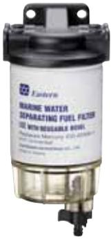
Filtro de combustible para fuerabordas con cabezal de aluminio, cazoleta transparente y racores. Filtro de 10 micras. Reemplaza filtro Mercury 35-60494-1, Racord S3123 y universales. Medidas 230x106 mm. Rosca del cabezal: 3/8" NTP. Manguera 10 mm.
