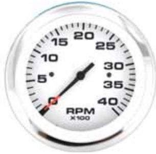
Para motores Diesel con conexión a la toma en E del alternador. Iluminación interior. Alimentación: 12 v. Diámetro de anclaje: 87 mm. Diámetro exterior: 96 mm.
