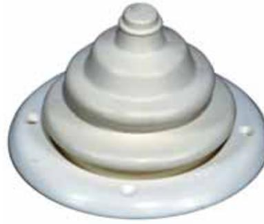
Pasacables para proteger los cables de dirección y control en la salida del casco y evitar la entrada de agua. Fabricado en PVC. Diámetro de la base 105 mm.
