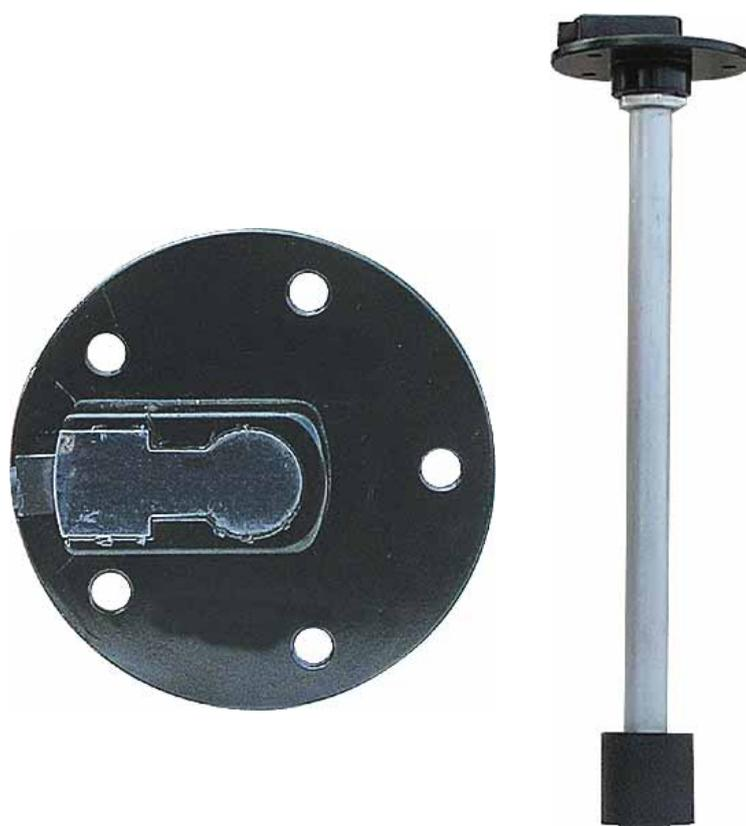
Aforador electrónico para agua sucias. Fabricado en plástico. Anclaje internacional de cinco orificios. Resistencia 180 ohms (VDO, Faria Europa, Yasaki, etc.)
