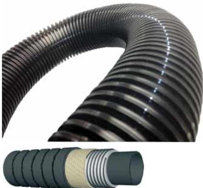
Manguera fabricada con caucho EPDM con superficie grecada, con refuerzo textil de alta tenacidad embebido en caucho con alambre en espiral e interior de caucho EPDM liso. Ideal para montajes con curvas extremas por su ductilidad. Temperatura de trabajo: -35 / +120 grados. Presión de trabajo: 5 Bars. Cumple normas ISO 1307. Rollos de 20 mts.
