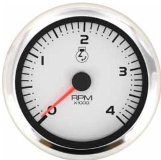
Para motores Diesel con conexión a la toma en E del alternador. Iluminación interior. Alimentación: 12 v. Diámetro de anclaje: 87 mm. Diámetro exterior: 96 mm. Dos posibilidades: Cuenta revoluciones solo o con cuenta horas incluido.
