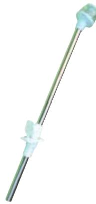
Luz todo horizonte telescópica (360°) para embarcaciones inferiores a 12 m, fabricada en policarbonato, lente de material acrílico y mástil de acero inoxidable. Altura máxima: 540 mm. Alimentación: 12 v. Bombilla 501030.
