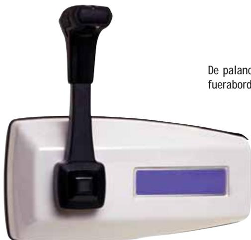
De palanca única y acción doble. Para embarcaciones con un motor. Aplicaciones: especial para motores fuera borda, intrafuera bordas (con colas) y fuera bordas. Montaje lateral superpuesto. Utiliza 2 cables tipo 33.
