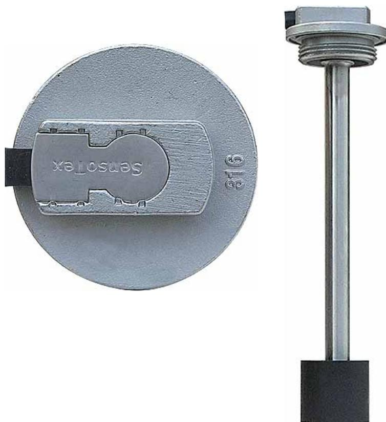
Aforador electrónico para combustible y agua. Fabricado en aluminio y goma. Anclaje internacional de cinco orificios. Dos resistencias 180 ohms (VDO, Faria Europa, Yasaki, etc.) y 240 ohms (Veethree, Faria USA, Veglia, Vetus, Aqua-Meter, etc.)
