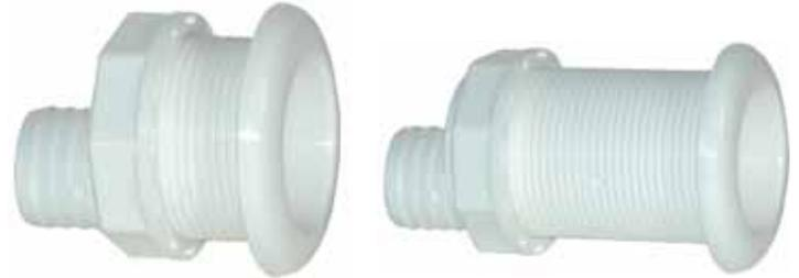
Conducto desagüe fabricado en material plástico de color blanco. Para manguera de 50 mm. Dos tipos: estándar y con válvula antirretorno. Diámetro interior 42 mm.
