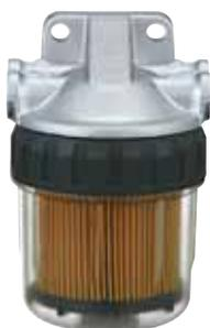
Filtro de combustible para fuerabordas e intrabordas con cabezal de aluminio, cazoleta completa transparente y racores. Filtro de 10 micras. Reemplaza filtro Mercury, Yamaha y universales. Rosca del cabezal: 3/8" NTP. Manguera 10 mm.
