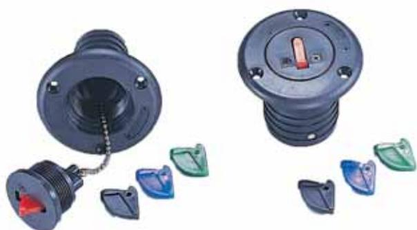
Para depósitos de agua, combustible y aguas negras. Fabricados en poliamida y fibra de vidrio de color negro. Se suministran con varios adhesivos y 4 pestañas de distintos colores, roja para gasolina, azul para agua, verde para gas-oil y negro para aguas negras. Diámetro total: 84 mm, altura: 65 mm.
