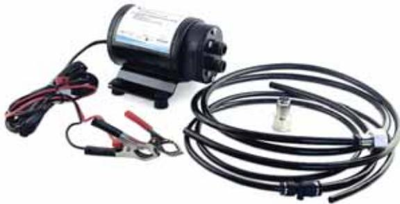
Electrobomba para la extracción de aceite de los motores especialmente marinos. Engranaje de Bronce, cuerpo de latón, autoaspirante y reversible. Se suministra con tubos de 6 y 8 mm, fusible, y cable eléctrico de 1,8 m con pinzas de batería incluidas. Peso: 0,4 Kg. Medidas: 140x90x80 mm. Conexiones de 13 mm. Norma CE-94/25/ECC, ISO8846.
