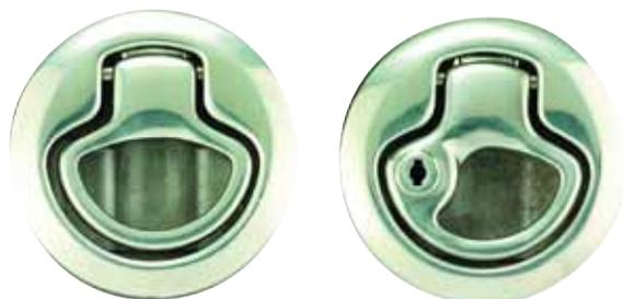
Cierre con tirador fabricado completamente en acero inoxidable AISI-316. Dispone de un mecanismo de apertura desde el interior. Estanco gracias a una junta de neopreno. Diámetro exterior 61 mm. Diámetro interior (montaje) 50 mm. Ancho máximo del mamparo, 10 mm.
