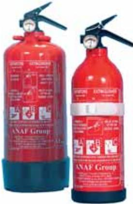
Extintores homologados según la directiva 96/98CE-98/85 CEE y 97/23EC. Certificados conforme a la norma Europa EN3/7 por B.V. para España. Agente extintor de polvo seco, presión incorporada. Para fuegos A-B-C. Cuerpo de aluminio pintado epoxy de color rojo, manómetro incorporado, válvula de latón hergonómica, boquilla de salida regulable a chorro o en abanico. Soporte antivibratorio de fácil instalación.
