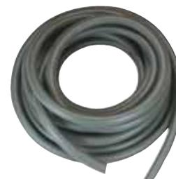
Tubería reforzada para hidrocarburos (gasolina, gasoil, etc.) Composición: Forro interior negro de caucho SBR/EPDM, exterior de caucho NBR con refuerzos textiles a base de cordones helicoidales de poliéster embebidos en caucho. Trenza antiestática incorporada a la pared de la manguera tipo 1900 T 19.
