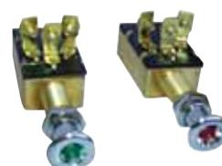
Interruptores de dos posiciones (ON-OFF) tipo tirador, iluminados en verde o rojo. Intensidad máxima 20 amp. a 12 v. Diámetro de anclaje: 10 mm, espesor máximo: 30 mm.
