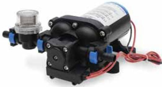
Bombas de presión de agua autoaspirantes, tres cámaras y cuatro membranas, presostato incorporado, para 3 puntos de agua. Conexiones: Entronques de entrada y salida tipo «Quick Connect» para tubo de 1/2" (13 mm). Filtro incluido. Cumplen normas 'CE.'
