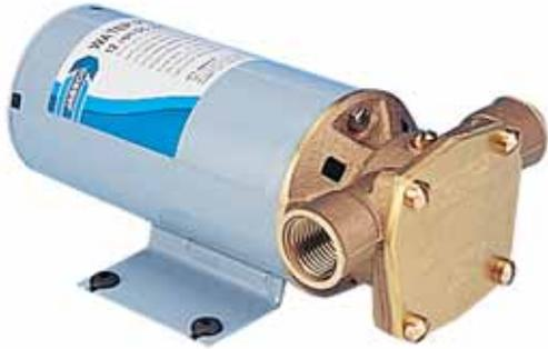
Bomba de achique eléctrica. Autoaspirante hasta 1,2 m, cuerpo de bronce, impulsor de nitrilo. Bocas de entrada y salida: 1/2", caudal: 32 litros/minuto.
