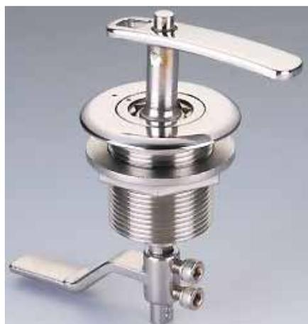
Cierre para tambuchos con llave de winche extraible, fabricado en acero inoxidable Aisi-316. Indicador de posición abierto o cerrado. Compresión del movimiento: 5 mm. Medida Total: 63,5. Medida de corte: 42 mm. Para espesor de tambucho de 8 a 32 mm.
