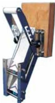
Para motores fueraborda. Fabricado totalmente en acero inoxidable con tratamiento electrolítico. Soporte para regular el ángulo de montaje en el espejo de popa. Cuatro posiciones para regular la altura del motor auxiliar. Para motores hasta 8 HP cuatro tiempos.
