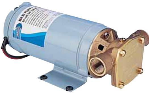
Bomba de achique eléctrica. Autoaspirante hasta 2,4 m, cuerpo de bronce, impulsor de nitrilo. Bocas de entrada y salida 1/2", caudal 50 litros/minuto.
