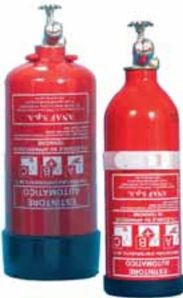
Extintores homologados según la directiva 96/98CE-98/85 CEE y 97/23EC. Certificados conforme a la norma Europa EN3/7 por B.V. para España. Incluye soporte y se activan cuando la temperatura alcanza los 79 grados. Para fuegos tipo A, B y C. Cuerpo de aluminio en el 2 kg y el resto de acero pintado en epoxy de color rojo. Válvula de latón. Apropiadados para cámara de motores.
