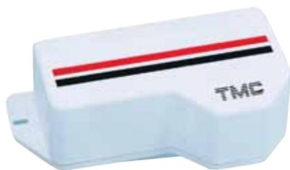
Motor limpiaparabrisas estanco. Fabricado en material plástico de color blanco resistente a los cambios de temperatura y a los impactos. Ángulo de barrido regulable (83, 100, 110 y 120°). Utiliza el brazo ref. 601501 y 601534 y las escobillas refs. 601502, 601503, 601536 y 601537. Cumple normas CE. Diámetro del eje: 14 mm, diámetro de la rosca de anclaje: 16 mm. Alimentación: 12 v.
