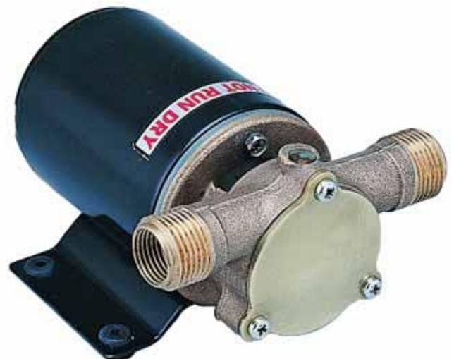
Autoaspirante, cuerpo de latón, impulsor de nitrilo y eje de acero inoxidable. Ideal para trasvase de líquidos y productos químicos. Bocas de entrada y salida 19 mm. Cebado automático, hasta 3 m de elevación vertical. Dirección de flujo reversible. Caudal 35 litros/minuto. Medidas: 160 x 90 x 120 mm. Peso 0,8 Kg.
