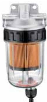
Filtro de combustible para fuerabordas con cabezal de aluminio, cazoleta completa transparente y racores. Filtro de 10 micras. Reemplaza filtro Mercury, Yamaha y universales. Rosca del cabezal: 3/8" NTP. Manguera 10 mm.
