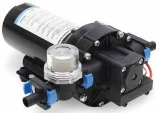
Bombas de presión de agua autoaspirantes, cinco cámaras y cuatro membranas, presostato incorporado, para 4 o 5 puntos de agua. Conexiones: Entronques de entrada y salida tipo «Quick Connect» para tubo de 1/2" (13 mm). Filtro incluido. Cumplen normas 'CE.'
